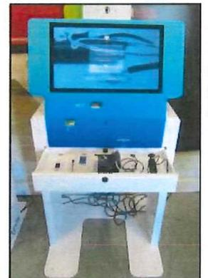
La borne de téléconsultation d'IPM a été conçue pour être facile d'utilisation tout en offrant aux utilisateurs la possibilité de réaliser quelques prises de données nécessaires à l'établissement d'un diagnostic (tension, etc.) via l'ajout de dispositifs médicaux adaptés.
